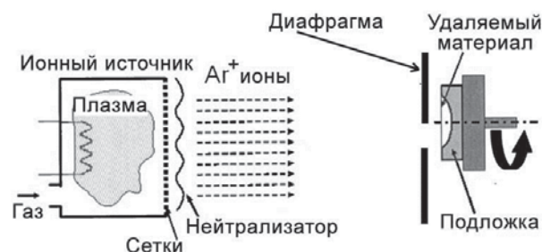
Рисунок 1. Схема процесса асферизации для случая осесимметричной асферики
