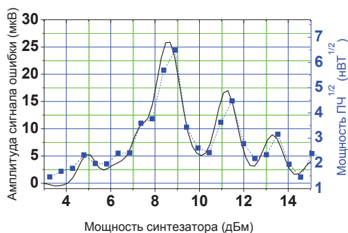
Рисунок 2. Амплитуда сигнала ошибки КГФД (левая ось, линия) по постоянному току и амплитуда сигнала ПЧ гармонического смесителя (правая ось, квадраты) на частоте 4 ГГц в зависимости от мощности опорного синтезатора.
