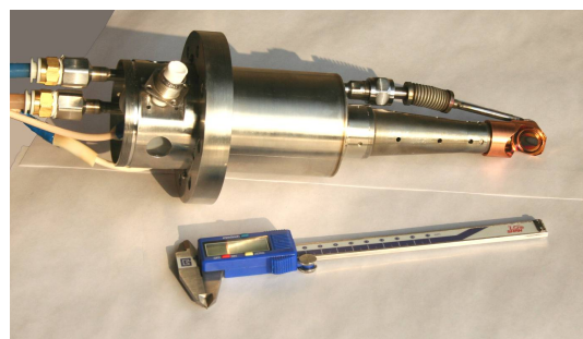
Рис.2 Внешний вид и габариты рентгеновской трубки.
