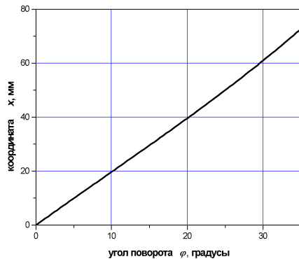
Рис. 2. Зависимость координаты x подложки на границе падающего потока атомов от угла поворота держателя.
